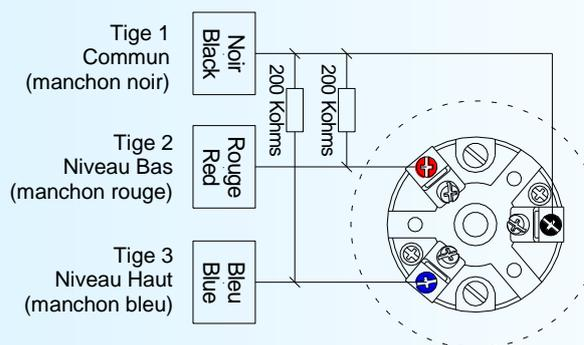
**Attention:** Si la sonde reliée au module ne possède pas ces résistances, la mesure de résistance sera fausse. Dans le cas de l'utilisation d'une sonde type SNL1000, il faut rajouter ces deux résistances.
